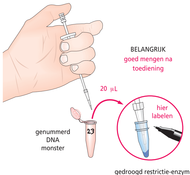
Figuur 3: Zo wordt het DNA en restrictie-enzym gemengd
